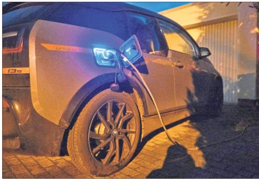
Da die meisten Autos zuhause die ganze Nacht über an der Wallbox hängen, reicht meist eine Wallbox mit elf Kilowatt.
